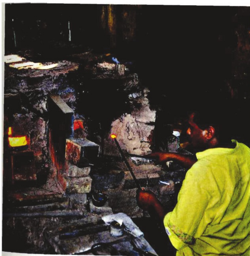
Рис. 57. Стеклодув перед глиняной печью (араб. at-tannur), Старый Каир, 1998. Он плавит стекло так же, как это делали в Древнем Египте.
